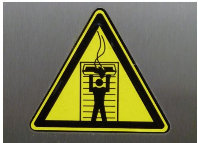
Abb. 13 Warnzeichen Verbrühungsgefahr – in 1,60 m am Heißluftdämpfer anzubringen
