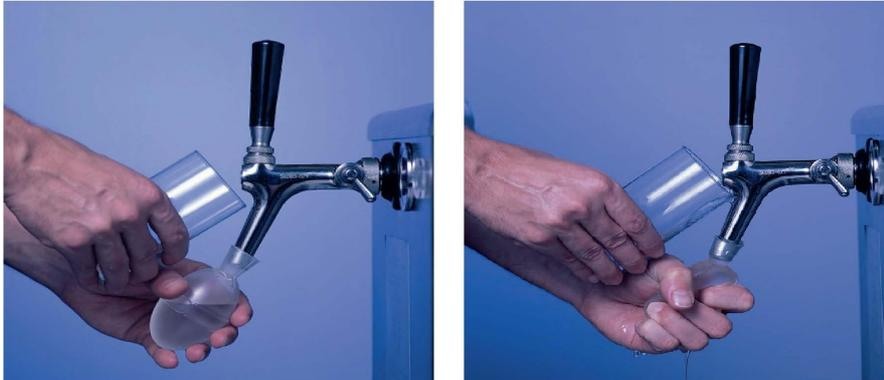
Reinigung des Hahnauslaufes und der Luftbohrung
