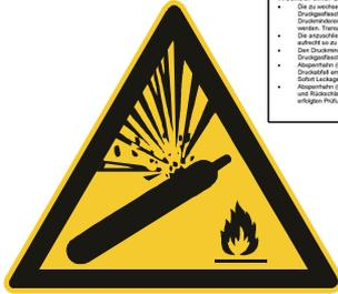
Kennzeichnung Räume mit angeschlossenen Druckgasflaschen → Warnzeichen W029 „Warnung vor Gasflaschen“
