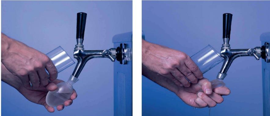
Reinigung des Hahnauslaufes und der Luftbohrung
