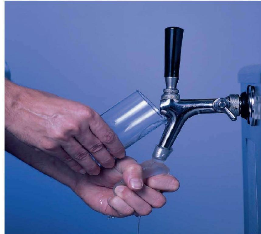
**Reinigung des Hahnauslaufes und der Luftbohrung
